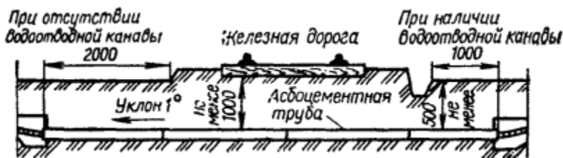
Рис. 3.2.2. Пересечение кабельной линией железной дороги.
