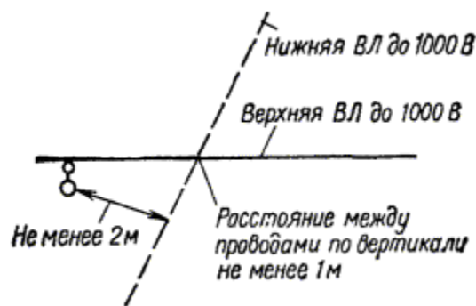
Рис. 3.3.1. Схема пересечения в пролете ВЛ до 1 кВ между собой.
