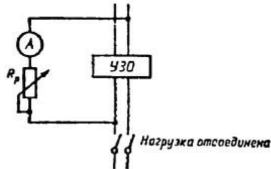
Рис. В.2. Схема проверки УЗО по методу 2.
